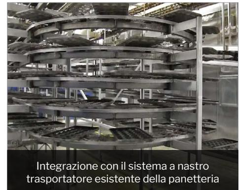
Integrazione con il sistema a nastro trasportatore esistente della panetteria
